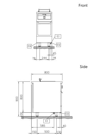
Electrical inlet (power) EQ Equipotential screw
